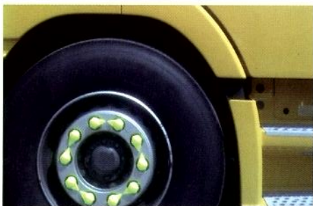
Angezeigt: Mit den „Checkpoint“-Radmutter-Indikatoren von Rema Tip Top erkennt man auf einen Blick, ob sich Radmutter lösen. Foto: Rema Tip Top
